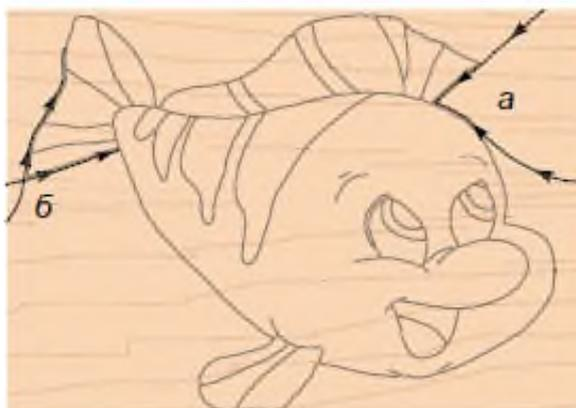
Рисунок 54 - Выпиливание острых внутренних и внешних углов
