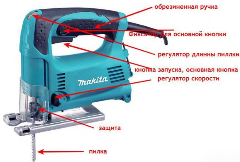
Рисунок 58 - Устройство электролобзика
